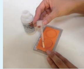
刃型に使用する場合には刃に直接塗り込むか、スponジゴムを抜いた溝に塗り込んでください。
